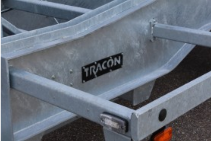
(191) Thermisch verzinken chassis
